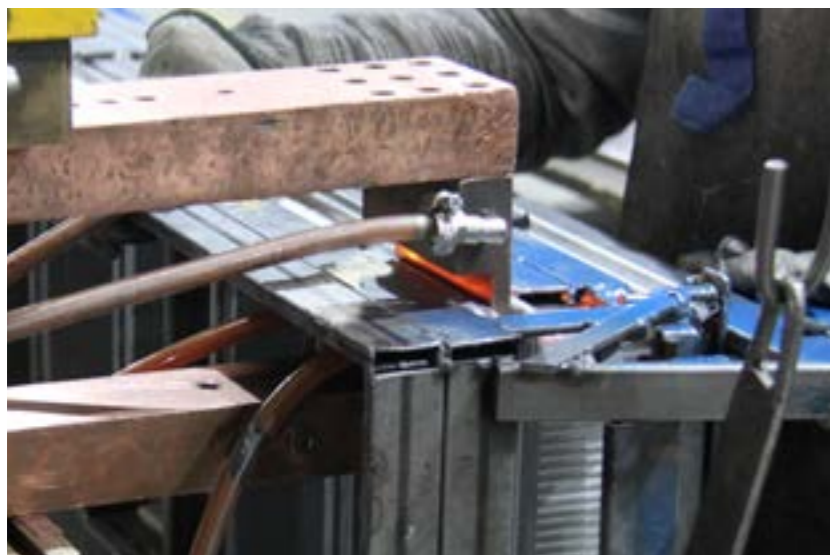
Soldadura por pontos Spot welding
